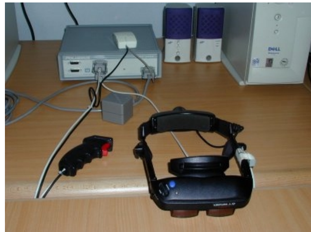
Abbildung 1: Die Hardware von Duplo umfasst einen FASTRAK-Tracker, einen Joystick mit integriertem Tracker-Receiver und die 3D-Brillen.
