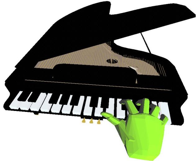
Abbildung 2: Mittels Datenhandschuh kann der Benutzer mit dem virtuellen Piano spielen und über MIDI den Synthesizer ansteuern.
