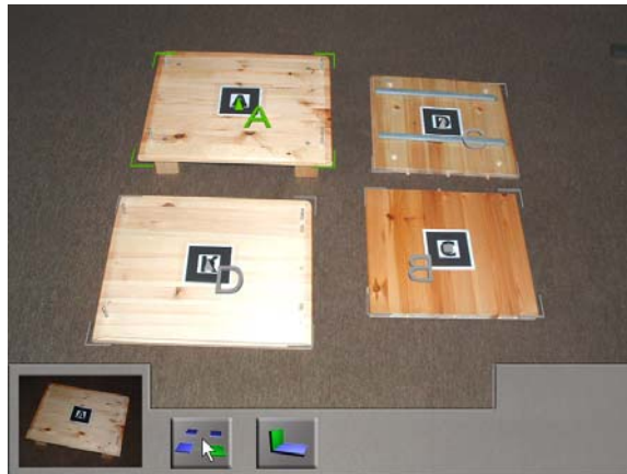
Abbildung 3.2: Rahmen markieren die erkannten Bauteile A, B, C, D und zeigen an, dass Bauteil A (grün markiert) gerade selektiert wurde. Zusätzlich ist am linken unteren Rand ein Bild des Bauteils A zu sehen.
