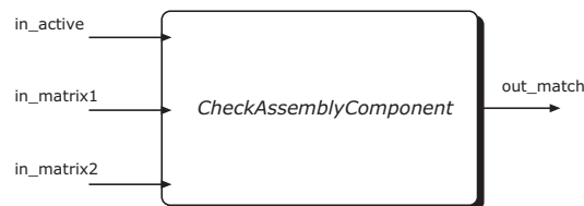
Abbildung 4.18: Komponente zum Ermitteln, ob ein Bauteil korrekt eingebaut wurde.
